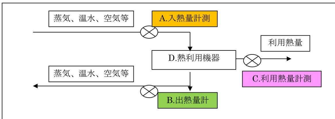
図1 熱利用量の測定装置設置場所
